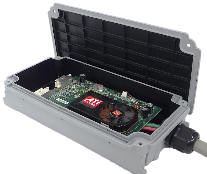
電磁波シールドケース （内部塗装）
