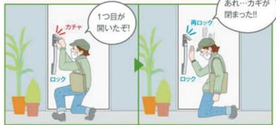
1つめのカギが不正に開けられても、50秒以内にもうひとつのカギを開けて扉を開けなければ、自動的に上下2つのカギが再ロックされ不正解錠を防止します。
