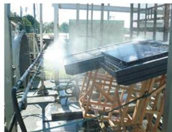
上記試験方法で、屋根材裏面への水漏れがないことを確認
